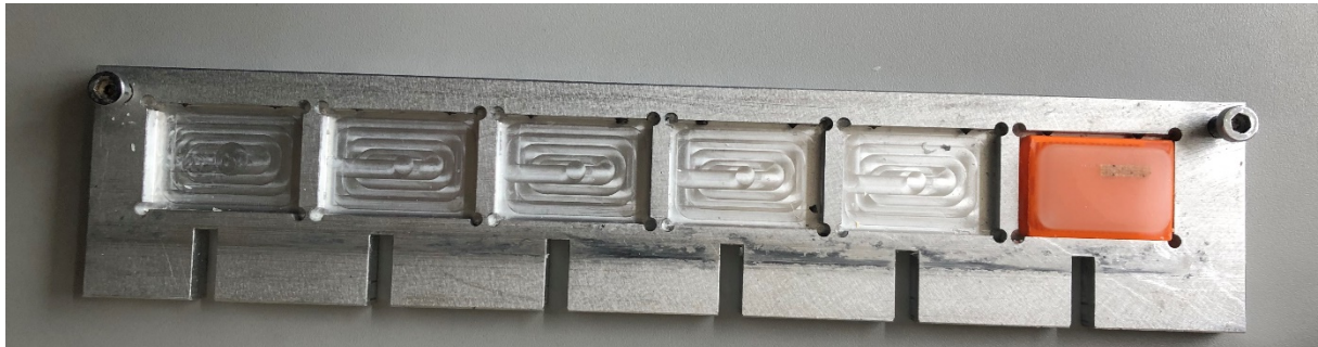
Abbildung 10: Mehrfachblockhalter, in dem Replikate untergebracht werden.
