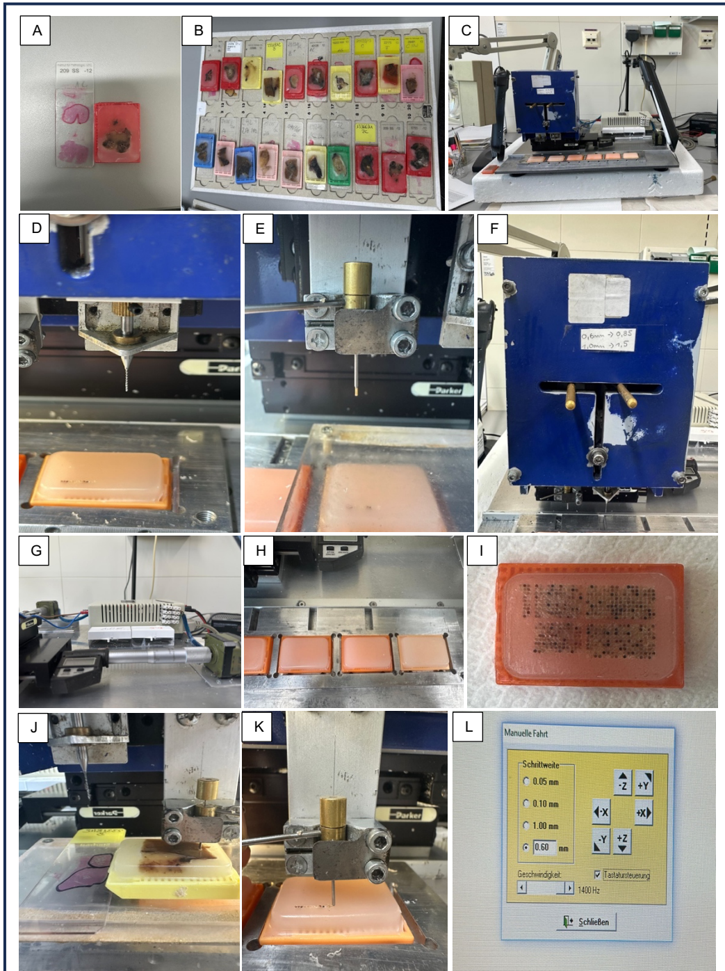
Abbildung 5: Wichtige Komponenten der TMA-Herstellung. Dargestellt ist der Gewebeschnitt mit dem korrespondierenden Gewebeblock (A), Vorsortierung der Spenderblöcke (B), der Gewebearray (C), der Bohrer mit 0.6mm Durchmesser (D), die Hohlneedle mit 0.6mm Innendurchmesser (E), die Umschaltvorrichtung (F), der elektrische Schrittmotor (G), der Mehrfachblockhalter (H), ein fertiger TMA (I), Entnahme von Gewebe aus dem Spenderblock (J), Platzierung des Gewebezylinders im Empfängerblock (K), Voreinstellung der Koordinaten (L).
