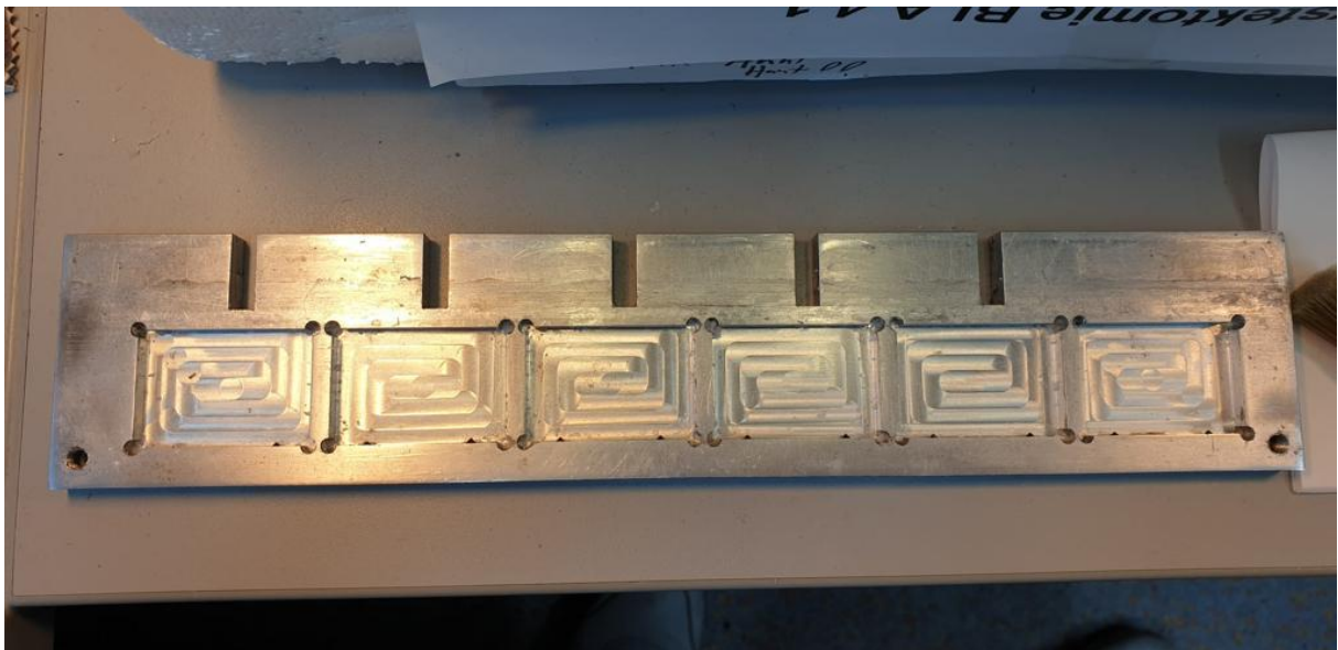
Abbildung 11: Hier ist ein Mehrfachblockhalter für die Herstellung von 6 TMA-Replikaten.
