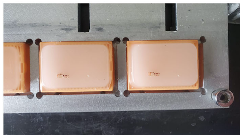
Detailansicht bereits teilweise gestanzter TMAs
