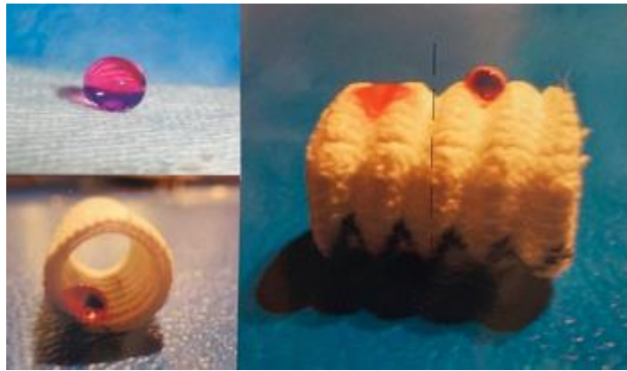
Abbildung 5: Makroskopische Eigenschaften einer beschichteten vs. unbeschichteten Prothese und Verhalten eines Wassertropfens auf einer beschichteten vs. unbeschichteten Prothese.
