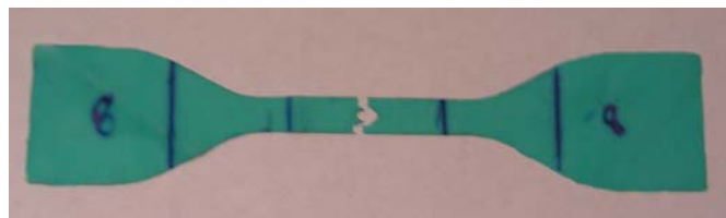
Abbildung 4.1-21: Unregelmäßiger Riß der Probe Nr. 8 KKD/dünn/Latex
