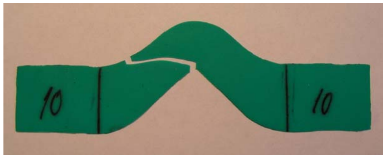
Abbildung 4.2-20: unregelmäßiger Riß der Probe Nr.10 /KKD Sympatic Dam/stark/Latex
