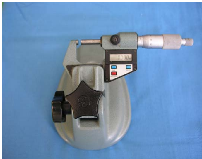
Abbildung 3.1-7: Meßgerät für die Dicke
