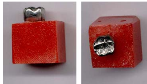
Abbildung 3.2-1: Zahn aus Simidur N-1 im Kunststoffblock
