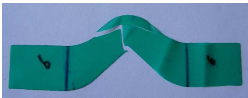
Abbildung 4.2-17: Unregelmäßiger Riß bei Fit Kofferdam/mittel/Latex
