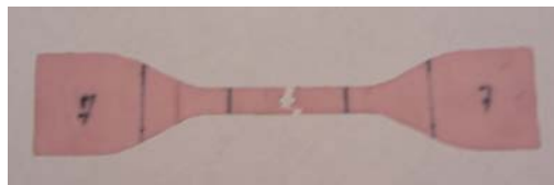
Abbildung 4.1-7: Unregelmäßiger Riß bei Hygenic/dünn/Latex
