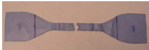
Abbildung 4.1-8: Unregelmäßiger Riß bei Hygenic/mittel/Latex
