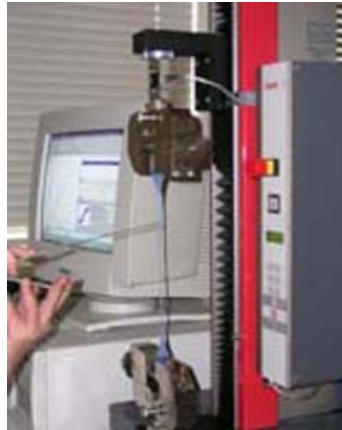
Abbildung 3.1-10: Messung der Dehnungslänge mit Hilfe eines Zirkels
