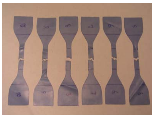
Abbildung 4.1-9: Unregelmäßiger Riß bei Hygenic/stark/Latex
