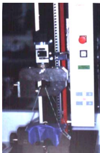
Abbildung 3.2-2: Kofferdamrahmen in der Zwick
