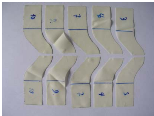
Abbildung 4.2-2: Unregelmäßiger Riß bei Dura Dental dam/ unbekannte Stärke/Latex
