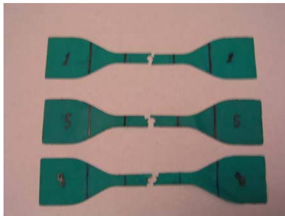
Abbildung 4.1-23: Unregelmäßiger Riß der Proben KKD/extra stark/Latex
