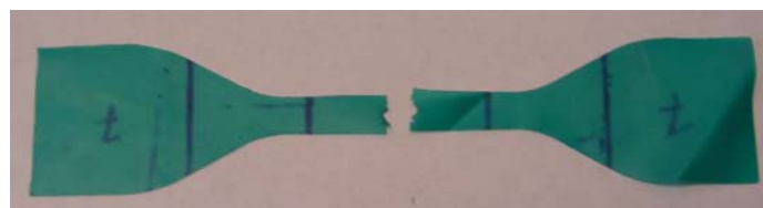
Abbildung 4.1-18: Unregelmäßiger Riß bei Fit Kofferdam/mittel/Latex
