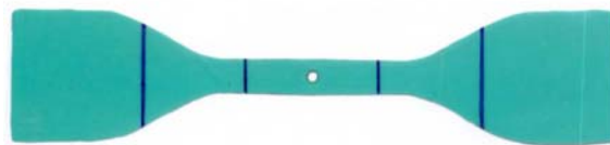
Abbildung 3.1-3: markierter und gestanzter Normstab („Dumb-Bell Probe“)
