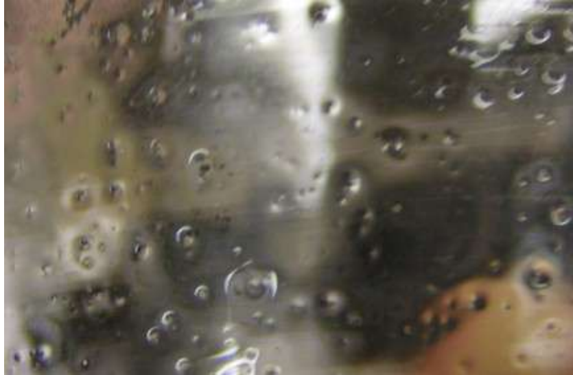
Abbildung 32: Makrogele einer 0,1 % Sulfoethylcellulose Lösung auf einer Glasoberfläche.
