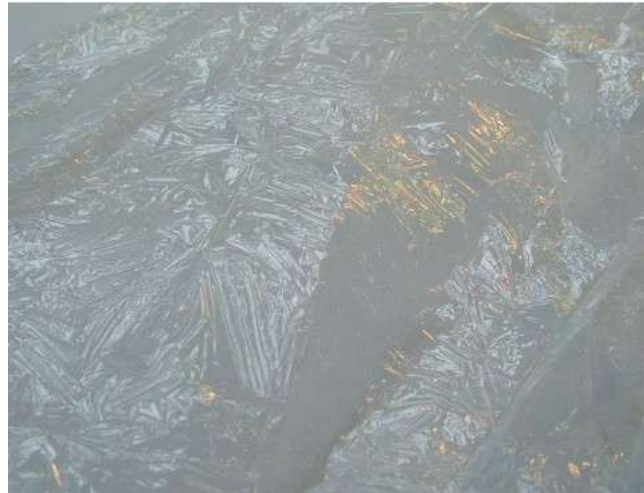
Abbildung 119: Mit Dienen modifizierte Symplexmembran aus SEC 1 und Chitosanfuranamid.
