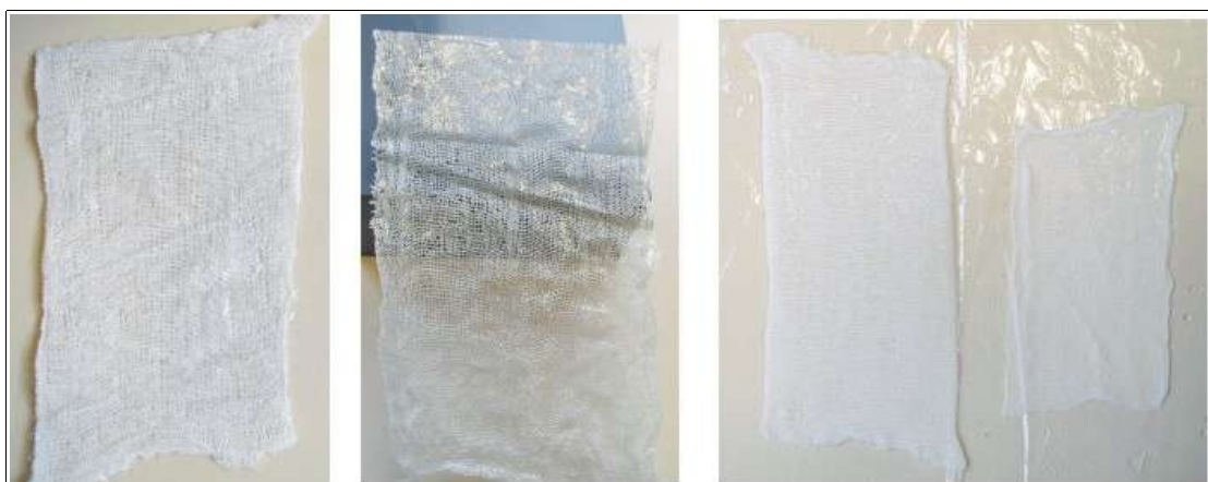
Abbildung 117: Verstärkte Symplexmembra von links: Elastomull® trocken, Mullbinde trocken, Elastomull® feucht, Mullbinde feucht
