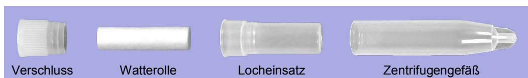
Bild 4.1: Schematische Darstellung einer Salivette ®
