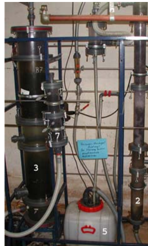
Abbildung 23: Verfahrensfließbild und Foto der Versuchsanlage bestehend aus Biowäscher, Biofilter und Aktivkohlefilter
