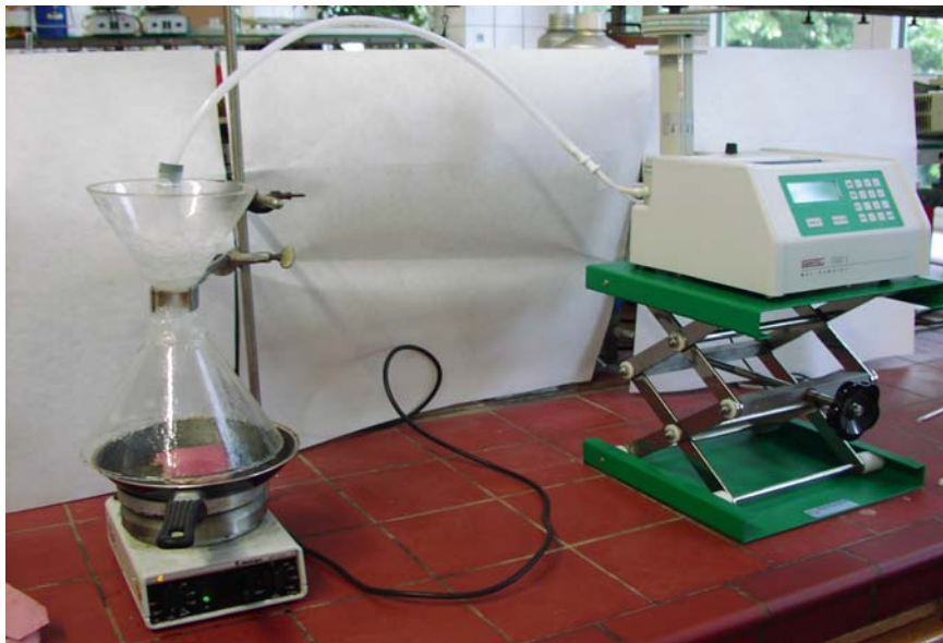
Abbildung 2: Apparatur zur Simulation des Bratprozesses und zum Adsorbieren der flüchtigen Verbindungen
