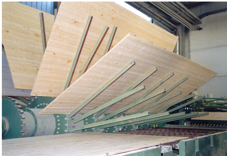
Abbildung 55 Abkühlung der Verbundplatten im Kühlstern nach der Presse
