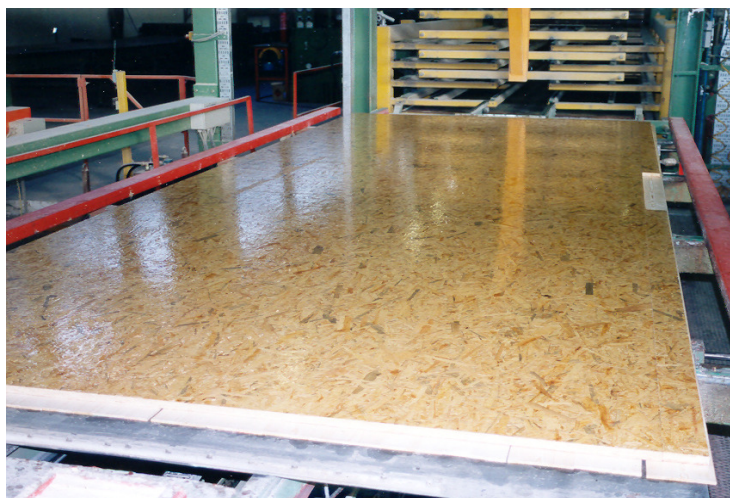
Abbildung 53 Beimte OSB als Mittellagen-Substitut, aufgelegt auf die untere Decklage der späteren Verbundplatte, Hauptachse der OSB in Längsachse (und damit nicht gesperrt) zur späteren Plattenlänge
