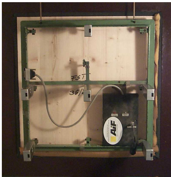
Abbildung 9 Messrahmen zur Aufnahme der Formänderungen senkrecht zur Plattenebene (links) mit schematischer Darstellung des Messrasters (rechts), Plattenabmessung 500 mm x 500 mm x Plattendicke
