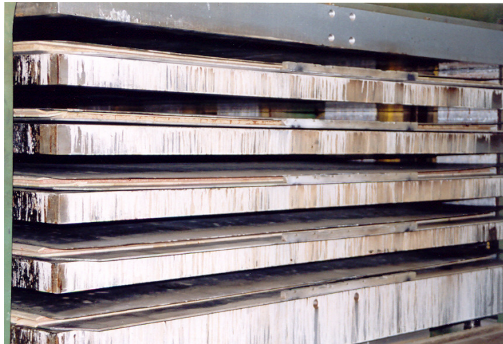
Abbildung 54 Beschickte Mehretagenpresse des Industriepartners
