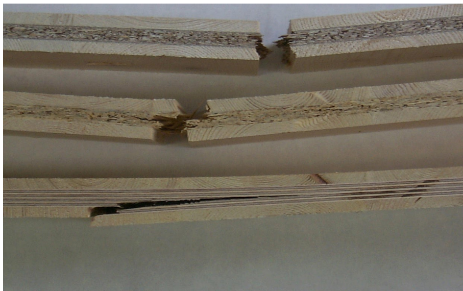
Abbildung 50 Bruchbilder von Biegeprüfkörpern bei Biegung rechtwinklig zur Plattenebene mit senkrecht orientierten Decklagenlamellen; Prüfkörper mit Spanplatten-, OSB-, und Sperrholz-Mittellage (von oben nach unten)
