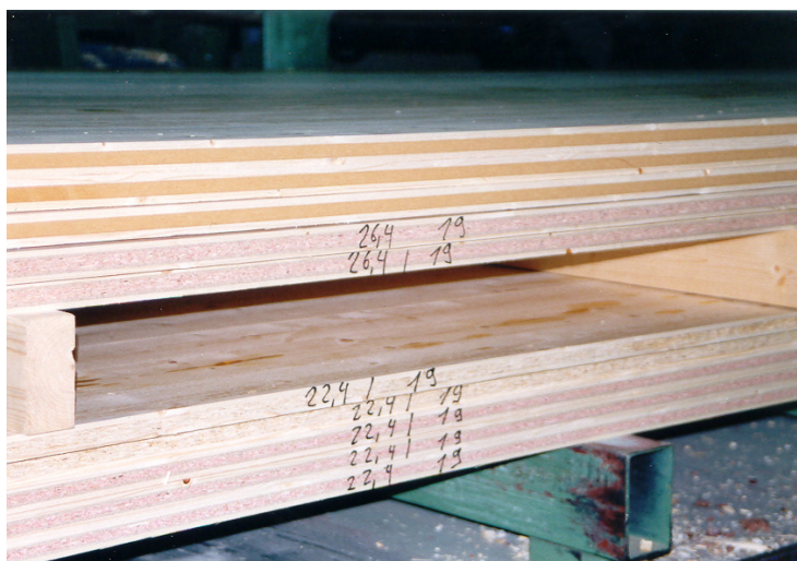
Abbildung 56 Konditionierung der Verbundplatten im Stapel
