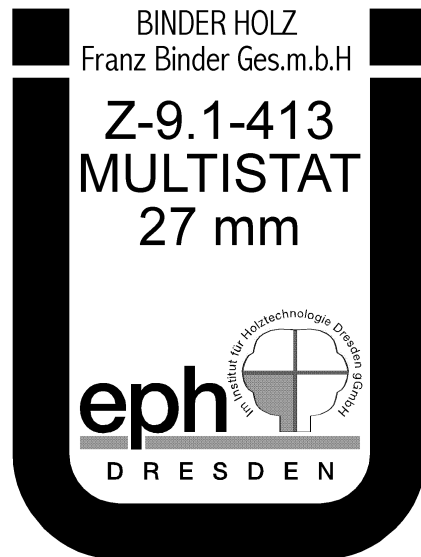
Abbildung 21 Übereinstimmungszeichen zur allgemeinen bauaufsichtlichen Zulassung von dreilagigen Massivholzplatten MULTISTAT der Fa. Binder
