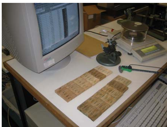
Abb. 5.16 Gewichtsbestimmung der Proben
