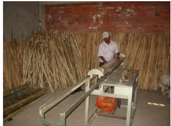
Abb. 5.39: Sägen der Latten ASOPRIG; Marsella-Rda.
