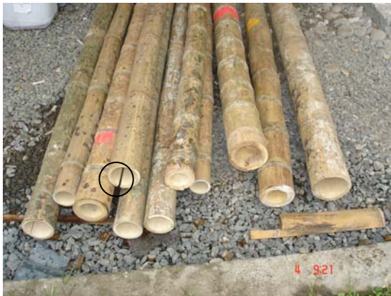
Abb. 5.97: Risse beim 1. Experiment
