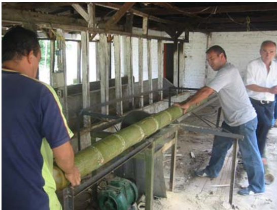
Abb. 5.38: Sägen der Halme in Abschnitte, GUADUALCA Alclá-Valle.
