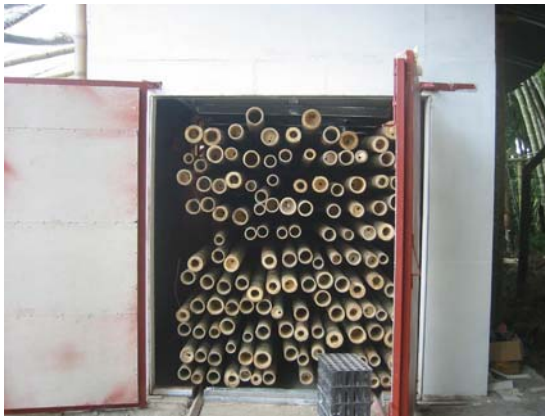
Abb. 5.89: Konventionelle Trocknung nach dem Frischluft-/ Abluftverfahren
