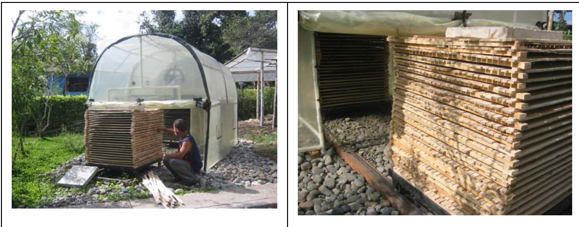
Abb. 5.63: Solartrockner im botanischen Garten der Technischen Universität von Pereira
