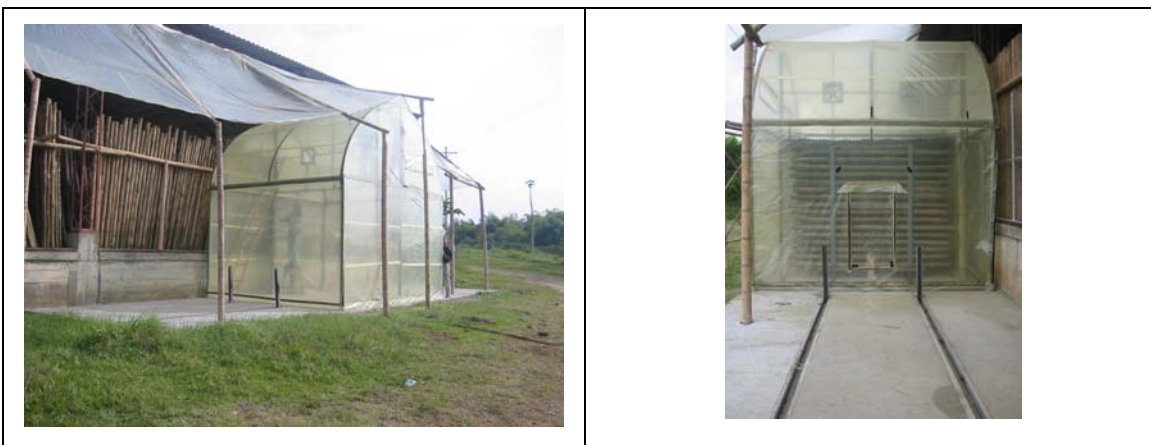
Abb. 5.76: Solartrockner für Halme mit einem Nutzungsraum für 500 Guaduas mit 3 m Länge, Experiment 5 und 6
