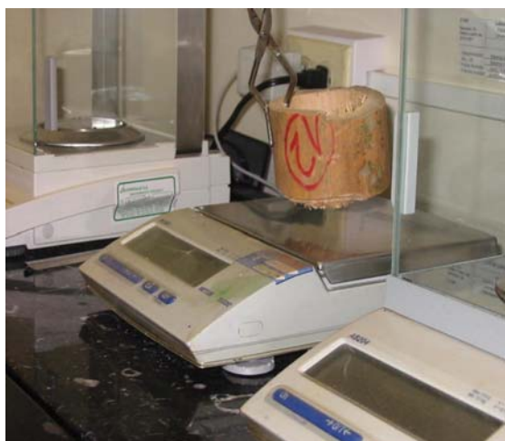
Abb. 5.81: Die Guaduproben bei der Gewichtsmessung Anfang
