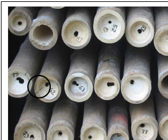
Abb. 5.107: Riss im Guadua-Halm im konventionellen Trockner, Experiment 3
