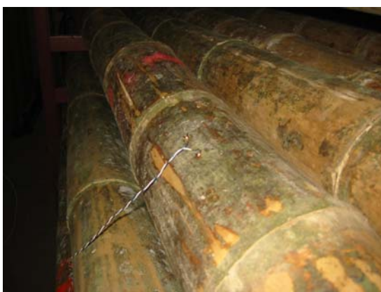
Abb. 5.93: Elektrische Feuchtemessung der Guaduahalme im konventionellen Trockner
