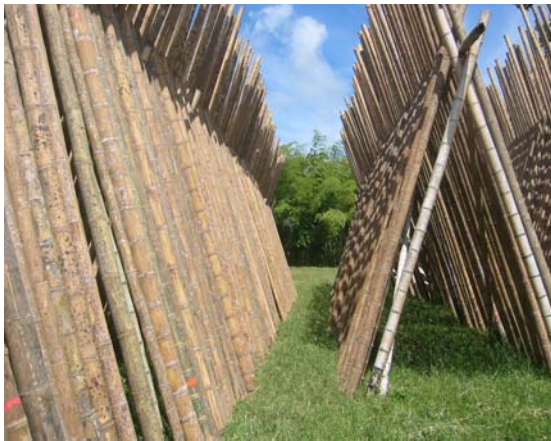
Abb. 5.27: Trocknung an der freien Luft, in Form von Stangen, Trocknungsprojekt der Guadua, Sägewerk Cerritos Ing. Luis G. García.
