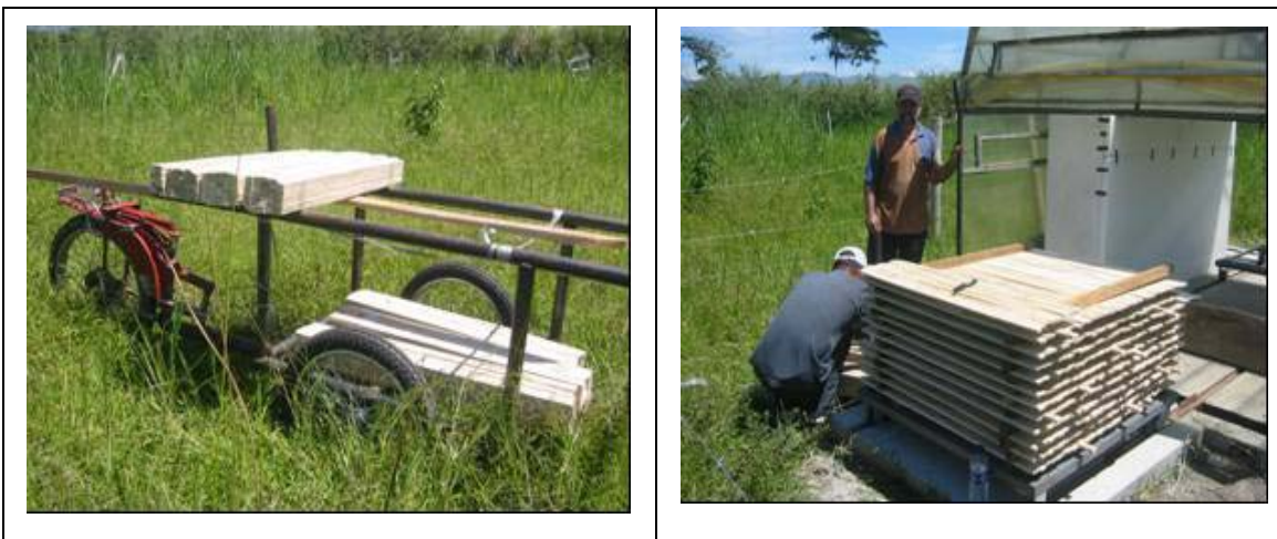
Abb. 5.53: Solartrockner in Cerritos, Sägewerk Ing. Luis Guillermo García
