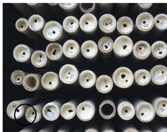
Abb. 5.108: Geringe Rissbildung im Experiment 3
