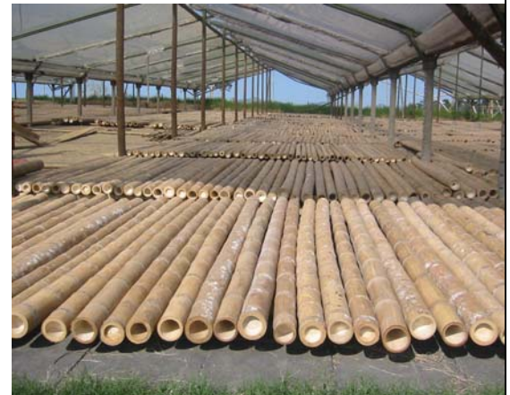
Abb. 5.28: Trocknung an der Freien Luft unter einem transparenten Dach aus Plastik, Finca del Sr. G. G. Londoño
