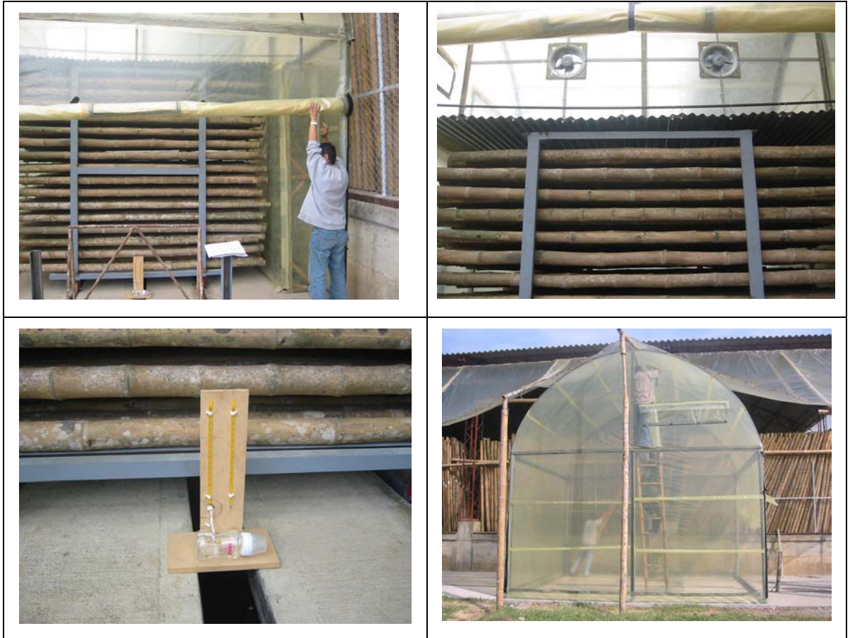
Abb. 5.77: Solartrockner für Halme mit einem Nutzungsraum für 500 Guaduas mit 3 m Länge, Experiment 5 und 6
