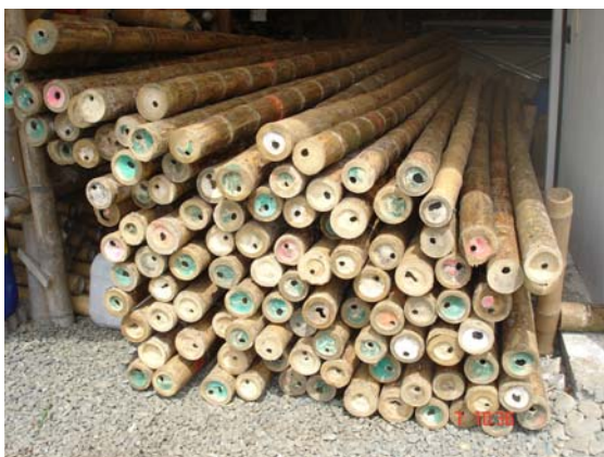
Abb. 5.29: Experiment 2, Halme mit durchbohrten Diaphragmen für Trocknung an der freien Luft
