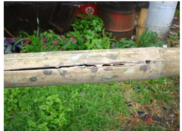
Abb. 5.98: Risse und Bläue beim 1. Experiment
