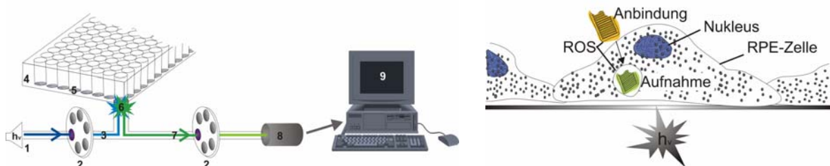
Abb. 2.8: (links) Prinzip des Zytofluorometers: (1=UV-Lampe, 2=Exzitationsfilter, 3=Exzitationslicht eines gewünschten Wellenlängenbereichs, 4=Zellkulturplatte mit 96-Loch, 5=konfluente Zellkultur, 6=Exzitation und Emission des Fluorchroms, 7=Emissionslicht vor dem Emissionsfilter, 8=Messung des gefilterten Emissionslichts durch einen Photomultiplier), 9=Computer mit Software zur Datenerfassung und Auswertung. (rechts) Schema der verwendeten Fluoreszenzmarkierungen im Phagozytoseassay: Die an die RPE Zellen angehefteten OS befinden sich in einer Pufferlösung mit einem pH von 9.0. SNAFL ® -2 emittiert dabei ein orangegelbfarbenes Licht. Die phagozytierten und mit Lysosomen (pH 6.0) fusionierten OS emittieren ein grünliches Licht. Aufgrund der DAPI gefärbten doppelsträngigen DNS emittiert der Zellkern Licht im Blaubereich. ( h\nu = Lichtquelle, ROS = rod outer segment = Photorezeptoraußensegment, Nukleus = Zellkern).
