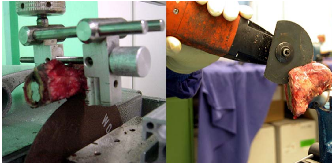
Abb. 10: Maschinelle und manuelle Längsschnittlegung
