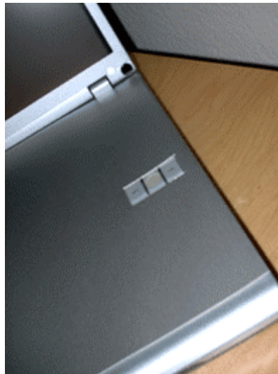
Abb.6: Abdeckung der Tastatur mit Aussparung der drei Pfeiltasten. Aufkleber auf mittlerer nach-unten -Taste.
