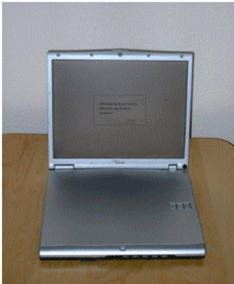
Abb.5: Laptop mit Startseite des Spellers und abgedeckter Tastatur. Abdeckung wird mit beidseitig klebendem Film am Laptop befestigt.
