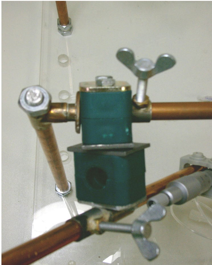
Abb. 2.2 Injektionsarm und Halteeinheit des MAGD-Systems
