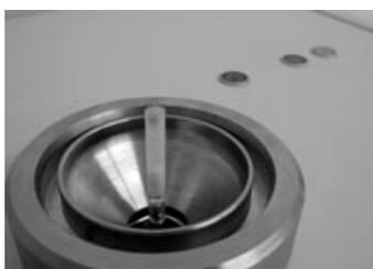
**Abb. 16. M-CT Probenröhrchen in Halterung. Zur Messung wird die Probe abgesenkt und die Öffnung mit einem Bleideckel verschlossen.**
