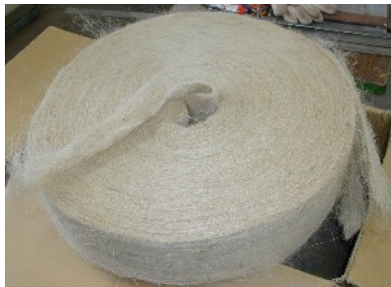
Abb. 4.1: Aufgewickelte und orientierte Kenaf-Faserbündel auf einer Rolle mit 12 cm Breite und einer Länge von ca. 200 m.
