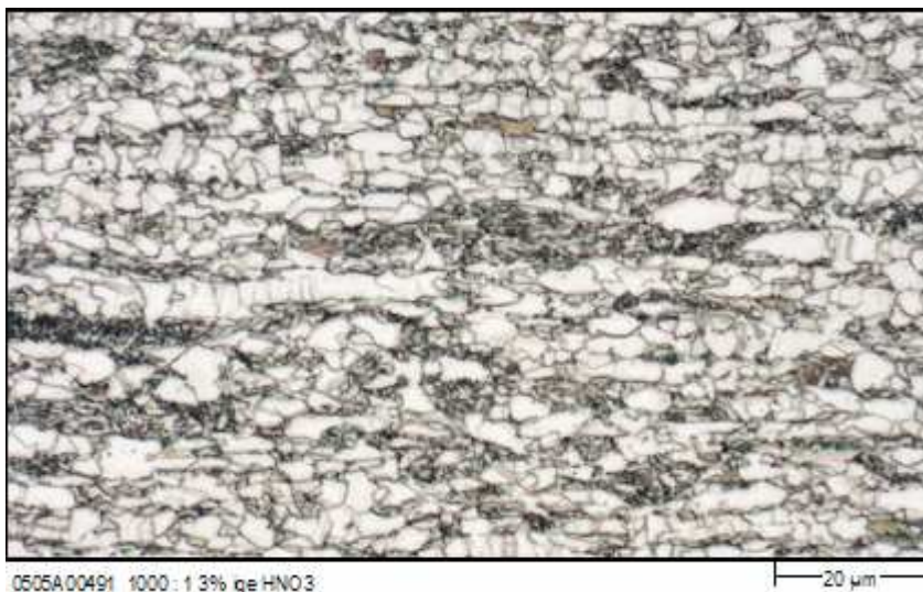
Abb. 48: Lichtmikroskopische Aufnahme eines mit Nital angeätzten TRIP-Stahls
