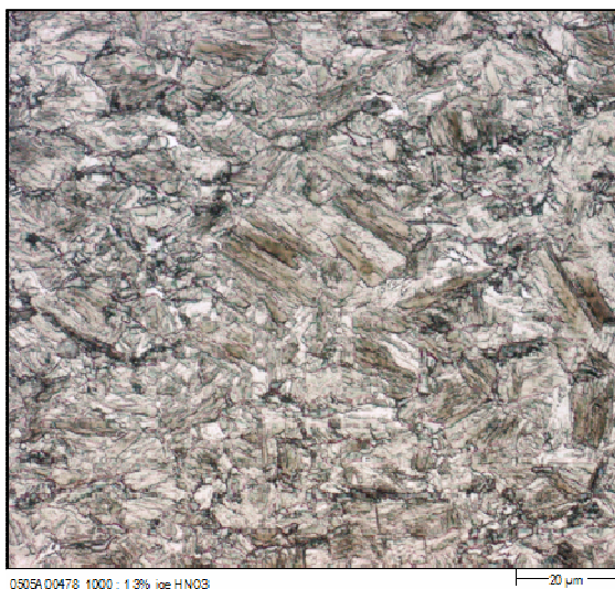
Abb. 45: Lichtmikroskopische Aufnahme eines mit Nital angeätzten Martensitphasen-Stahls
