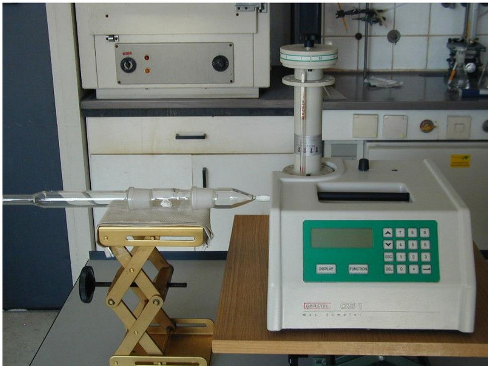
**Abbildung 9:** verwendeter Oral Breath Sampler
