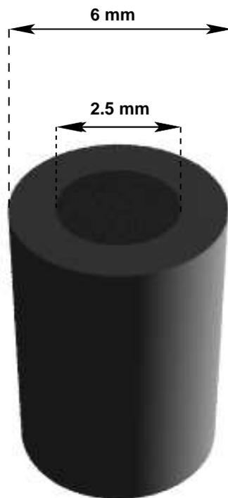
**Abbildung 3.3.** Stäbchen von durch Spritzgussverfahren hergestelltem Polyethylen.
