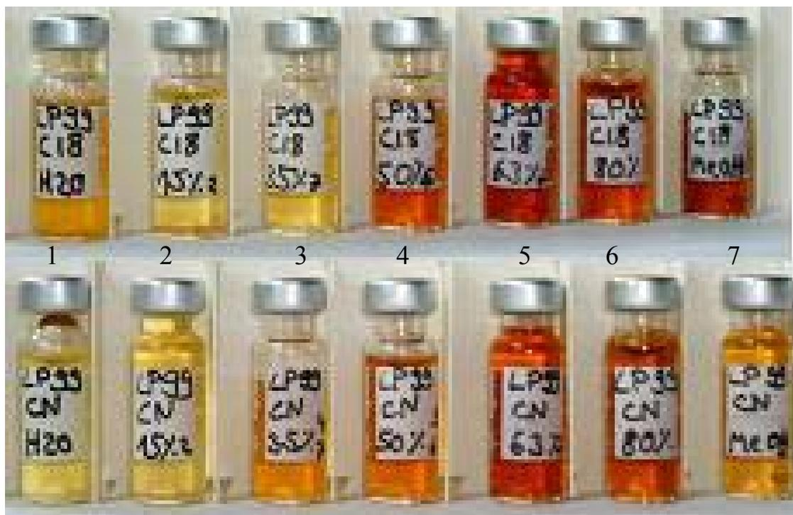
Abbildung 47 Fraktioniertes Pyrolyseöl aus Fichte nach Umkehrphase C18 (oben) und CN (unten), Elution: Wasser mit steigenden Anteilen an Methanol (1. reines Wasser; 2. 15 % Methanol; 3. 35 % Methanol; 4. 50 % Methanol; 5. 63 % Methanol; 6. 80 % Methanol; 7. reines Methanol)
