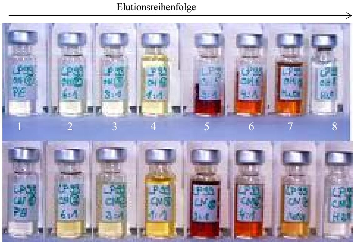
Abbildung 45    Fraktionen von Pyrolyseöl Buche nach Festphasenextraktion über Normalphasen (oben: SPE Diol, unten: SPE CN) Elutionsmittel [Methanol (MeOH), *tert*-Butylmethylether (MTBE); Petrolether (PE) (Siedebereich 40 °C - 60 °C)] : 1. PE; 2. PE:MTBE 6:1; 3. PE:MTBE 3:1; 4. PE:MTBE 1:1; 5. MTBE:MeOH 9:1; 6. MTBE:MeOH 4:1; 7. MeOH; 8. Wasser
