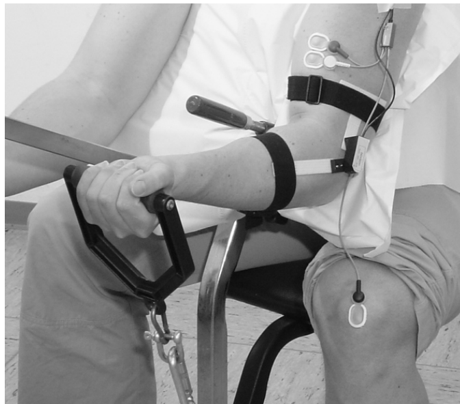
Abbildung A2: Ableitelektroden, Goniometer und Positionierung der Probanden während der isometrischen Kontraktionen an der Federwaage
