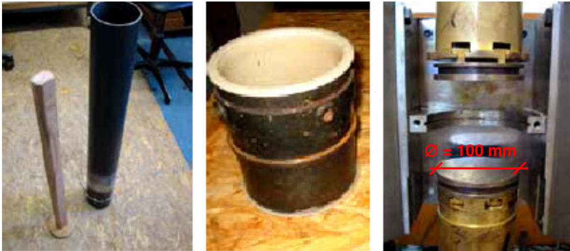
Abbildung 20: Verdichtungszyylinder (links), Presszylinder (mittig) und Presskolben mit Presszylinder Aufnahme (rechts)
