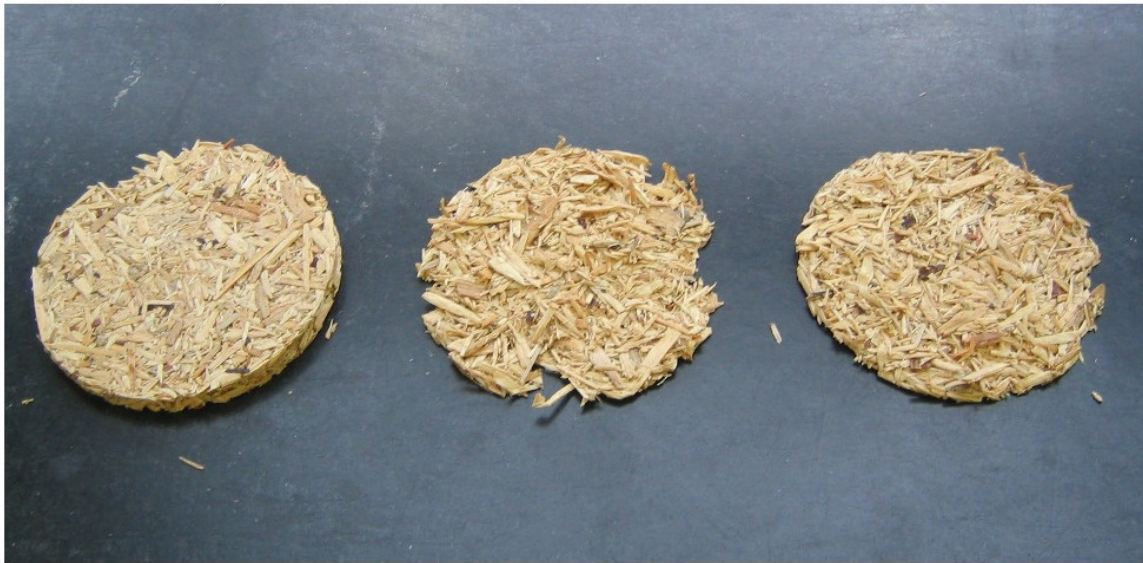
Abbildung 17: Spanprobe aus Mittelschichtspan (links) und nach Querzugtest (mittig und rechts).
