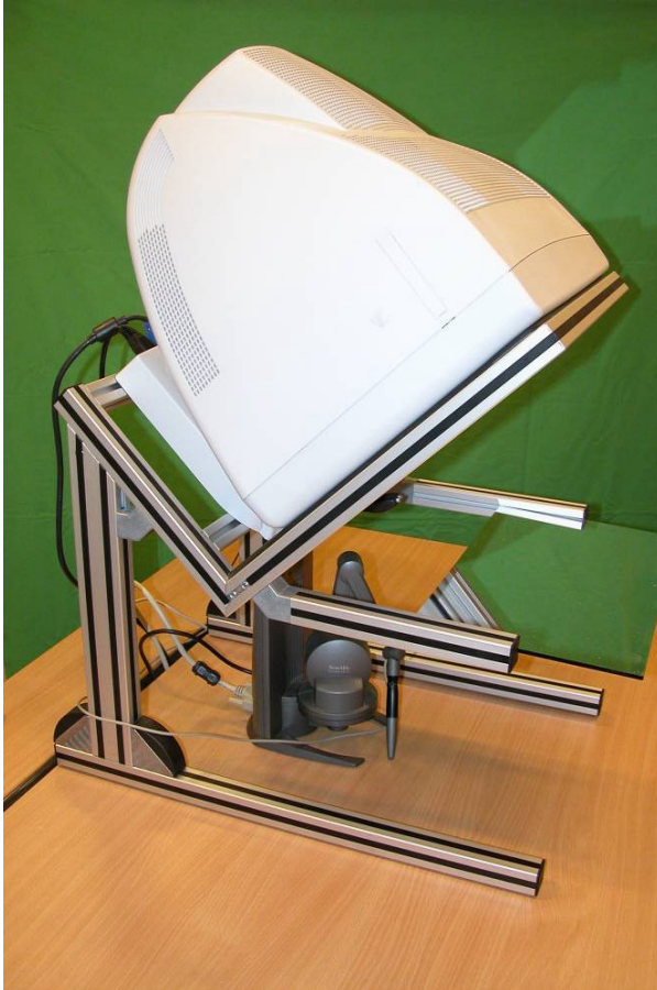
Abbildung 15: Aufbau des Simulators zur virtuellen Wurzelspitzenresektion. Der Spiegel im Gesichtsfeld des Probanden reflektiert das Bild eines Monitors. Dieser ist mit einem Computersystem verbunden, das die VOXEL-MAN Simulationssoftware wiedergibt. Durch eine Rahmenkonstruktion werden alle Komponenten räumlich so positioniert, dass der Proband das Krafrückkopplungsgerät hinter dem Spiegel nicht sieht. Alle Bewegungen des Krafrückkopplungsgerätes werden auf die Lage eines virtuellen Werkzeugs übertragen. Dies ermöglicht dem Probanden die gezielte Interaktion mit dem virtuellen Modell
