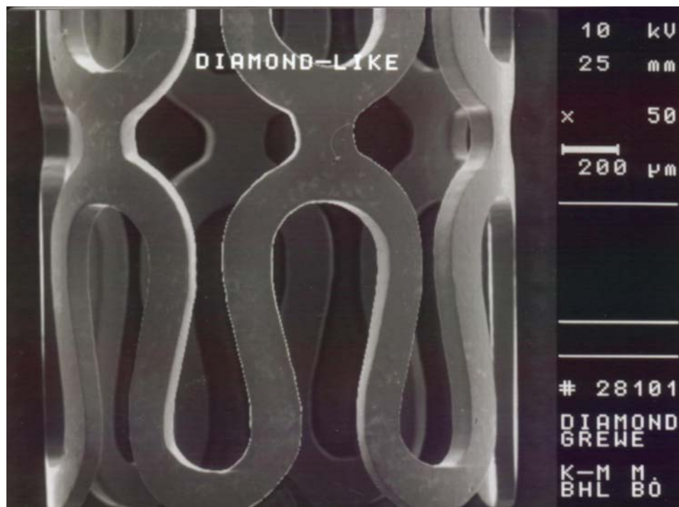
Abbildung 1: DLC-beschichteter Stent in 50facher Vergrößerung (mit freundlicher Genehmigung von Dr. P.H. Grewe; Abteilung für Kardiologie und Angiologie, Universitätsklinik Bergmannsheil, Bochum)
