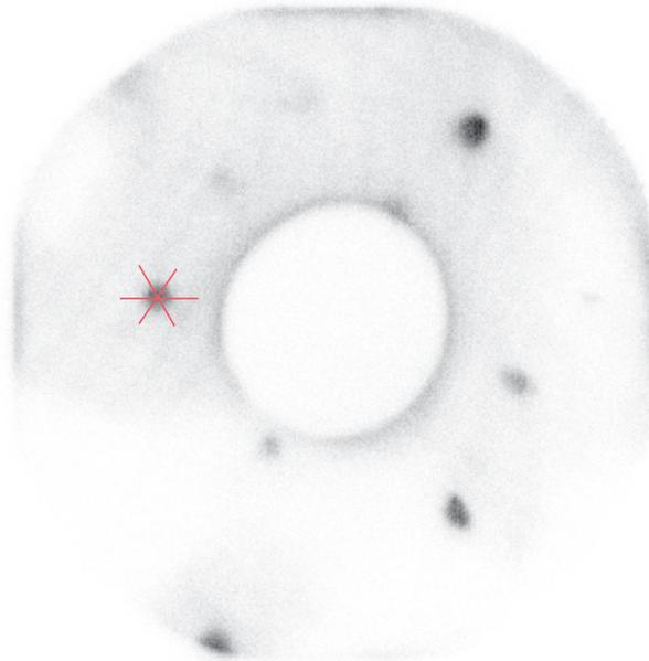
Abb. IV.23: Beugungsbild einer dicken Kupferschicht auf einem Eisenwhisker. Die roten Linien zeigen die Linienintensitätsprofile für die Ermittlung der durchschnittlichen Reflexbreite.
