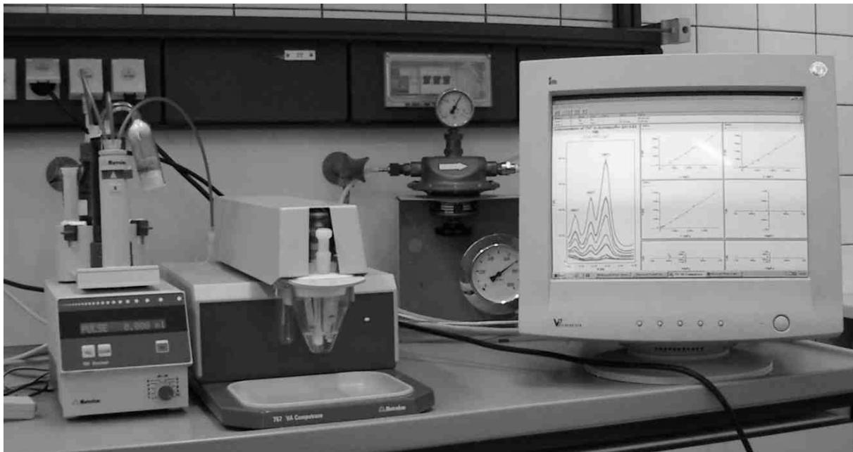
**Abb. 24:** Messaufbau mit Voltammetriesystem Computrace 757, Dosimat 693 und Zusatzdruckminderer (im Hintergrund)
