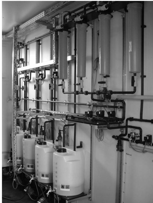
**Abb. 99:** RGS-Kartuschen und Eluentenbehälter im Container in Elsnig [150]
