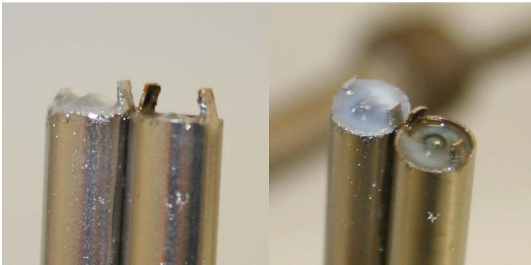
**Abbildung 6-6: Auswirkungen des Messverfahrens auf die Elektrode**
