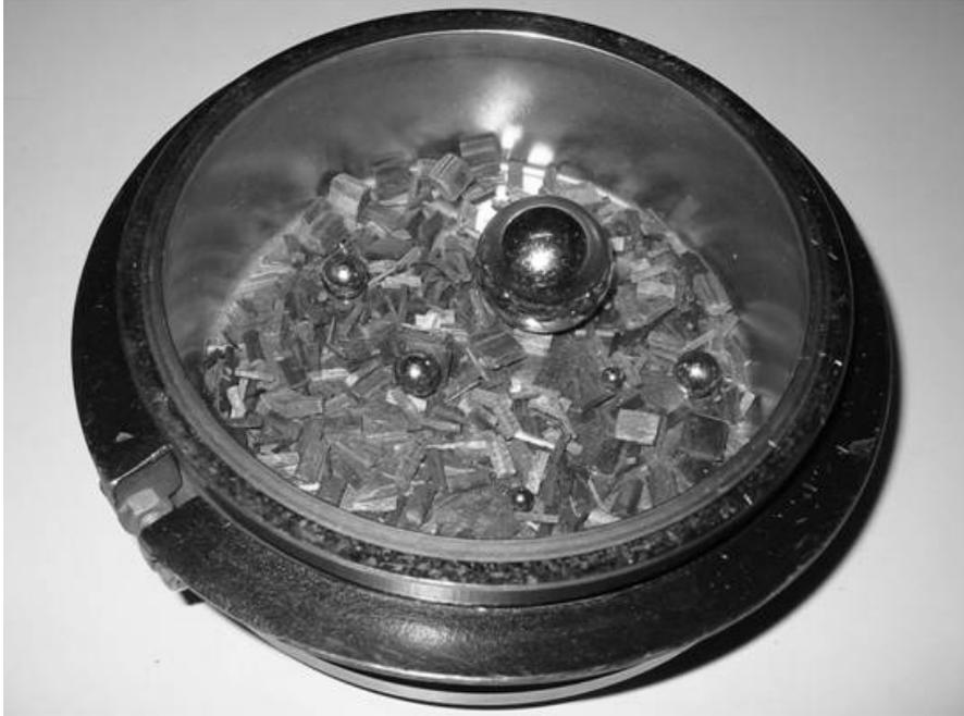
**Abb. 7. HEMI-Prüfung: Edelstahlschlagbecher samt Fragmenten und Stahlkugeln.**
