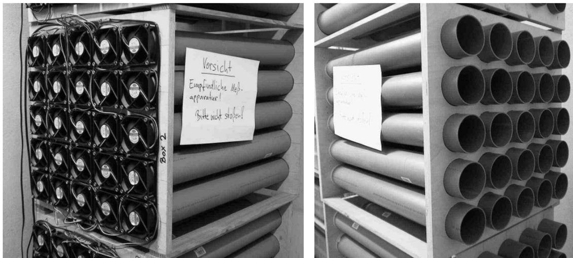
**Abb. 10. Aufbau der Versuchseinheiten aus jeweils 25 kalibrierten Windkanälen.**
