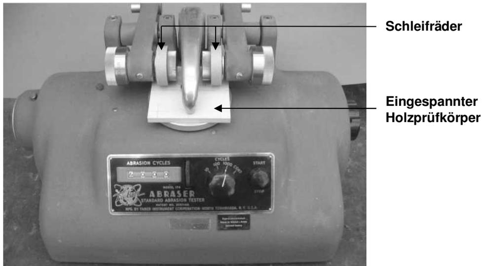
Abb. 9. Versuchsaufbau für die Taber-Abraser-Methode mit eingelegter unbehandelter Kontrolle.
