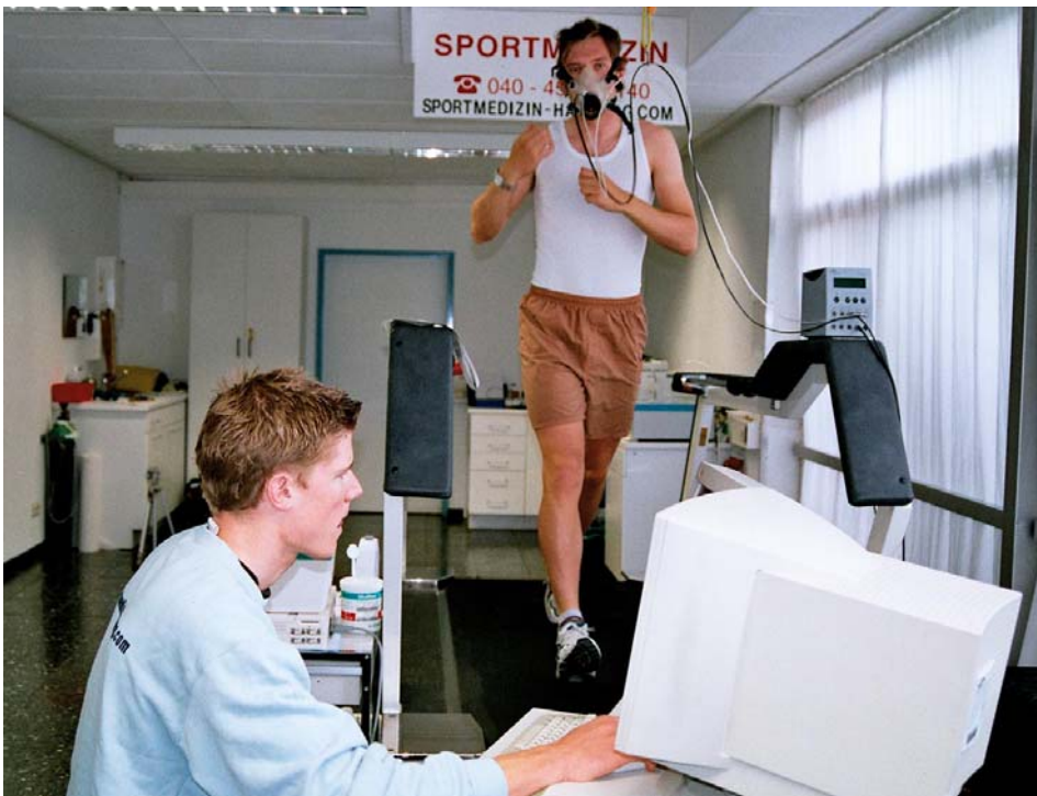
Abbildung 13: Laufbandspiroergometrie - Spirometerschläuche sind an einer von der Decke hängende Schlaufe vor dem Probanden befestigt, um den Bewegungsablauf des Probanden nicht zu stören – Spirometer steht rechts – Untersucher verfolgt Spirometrie am PC
