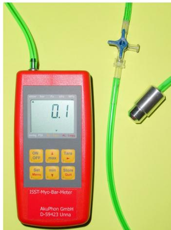
**Abbildung 10:** Das eingesetzte Myobarmeter.
