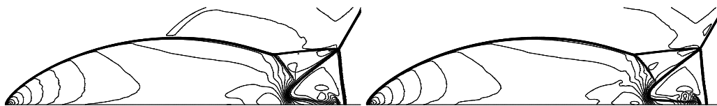
Abbildung 4.13: Links: WENO-Rekonstruktion mit Polynomgrad eins. Rechts: WENO-Rekonstruktion in entkoppelten Variablen mit Polynomgrad zwei. h = 1/200 . 35 Isolinien der Dichte ab 1.39 mit Abstand 0.6.
