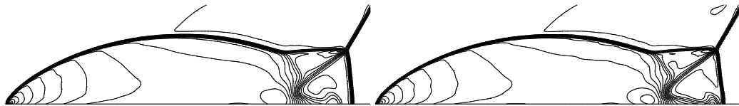
Abbildung 4.10: Digitale ENO-Rekonstruktion (links) und WENO-Rekonstruktion (rechts), jeweils Polynomgrad eins, h = 1/100 . 35 Isolinien der Dichte ab 1.39 mit Abstand 0.6.
