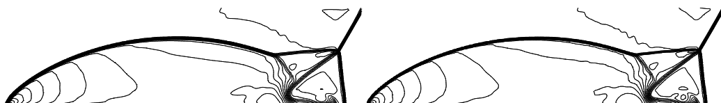
Abbildung 4.12: WENO-Rekonstruktion mit Polynomgrad zwei. Links: Lokaler Lax-Friedrichs Fluss mit skalarwertigem Diffusionsfaktor. Rechts: Rekonstruktion in entkoppelten Variablen. h = 1/100 . 35 Isolinien der Dichte ab 1.39 mit Abstand 0.6.
