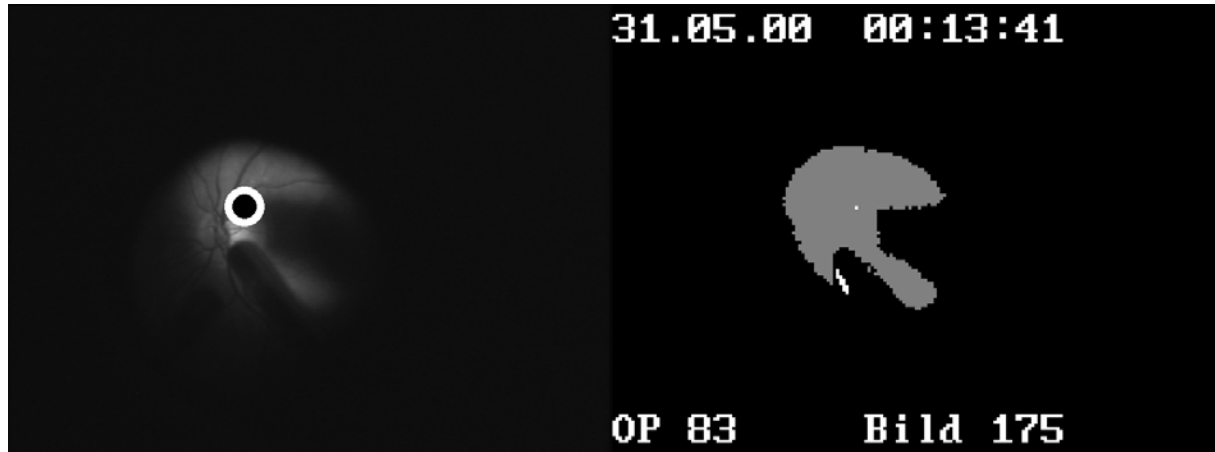
Abbildung 2.3: Digitalisiertes Original-Videobild mit Markierung des durch das ETS berechneten Helligkeitszentrums (links). Auf der rechten Seite ist das umgewandelte Graustufenbild zu sehen.
