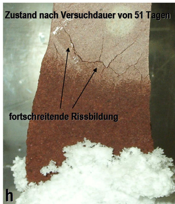
Abb. 75e-h: Fotografische Darstellung des experimentellen Verlaufs bei 40 °C
