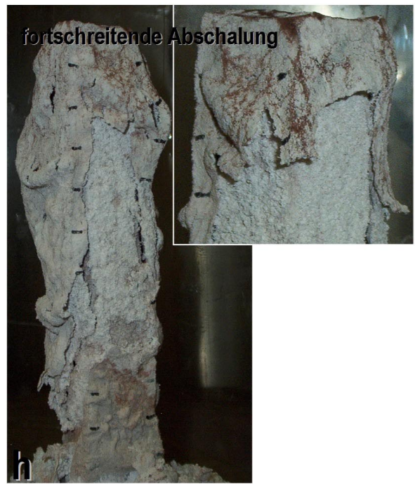
Abb. 73e-h: Fotografische Darstellung des experimentellen Verlaufs bei 28 °C
