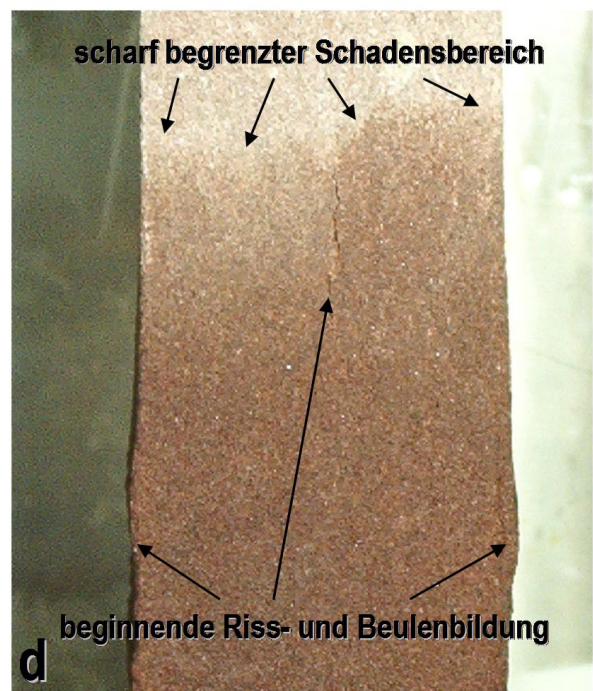
Abb. 75a-d: Fotografische Darstellung des experimentellen Verlaufs bei 40 °C
