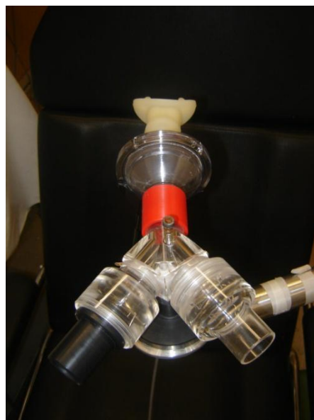
Abbildung 6: Mundstück, Pneumotachograph und T-Stück für Dyspnoe-Induktion
