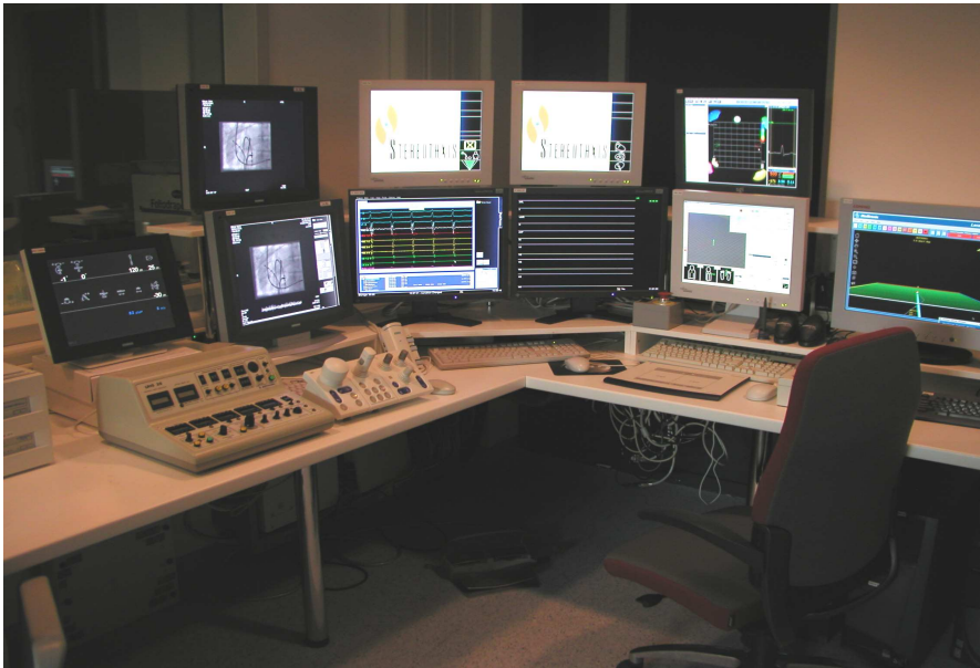
Abb. 5: Von Röntgenstrahlung abgeschirmter Kontrollraum des Stereotaxislabors mit Navigations-, Röntgen- und EPU Monitoren, sowie Vorrichtungen für die Fernsteuerung des magnetischen Katheters.
