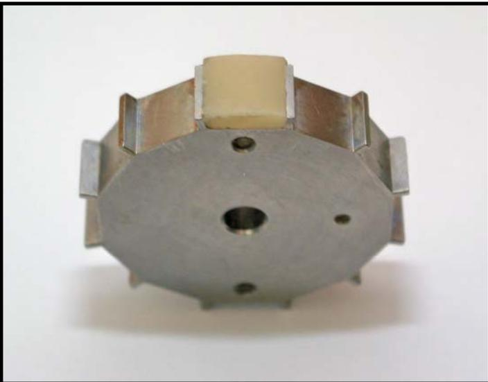
Abb. 5: Mit Komposit befüllte Kammer im Detail.
