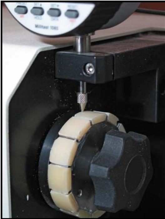
Abb. 14: Vermessung der Schleifspur
