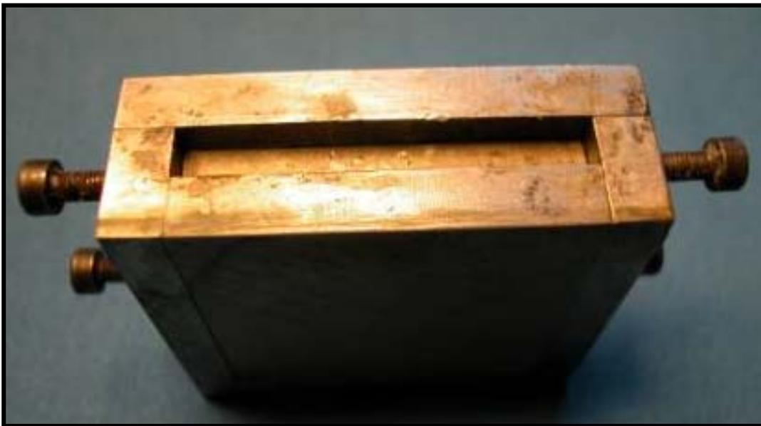
Abb. 8: Matrize zur Prüfkörperherstellung
