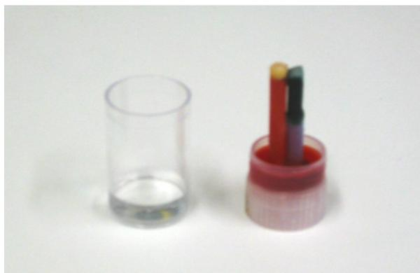
Abbildung 3-2: Ein Probekörper mit Glasionomerzement (roter Schaft) und Schmelzprobe (grüner Schaft) im Lagergefäß-Deckel
