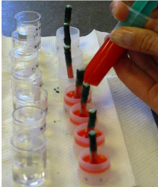
Abbildung 3-1: Herstellung der Probekörper: Einbringen der Schmelzproben in die Gefäßdeckel
