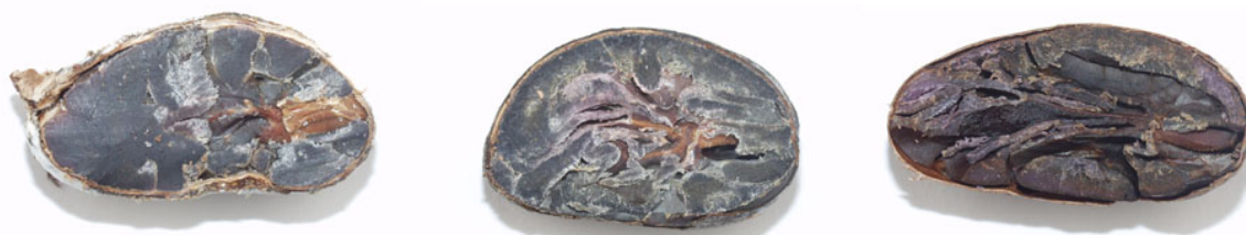
Abb. 15 Schnitt-Test Beispiel je eines schiefrigen , schiefrig-violetten und violetten Rohkakaosamens
