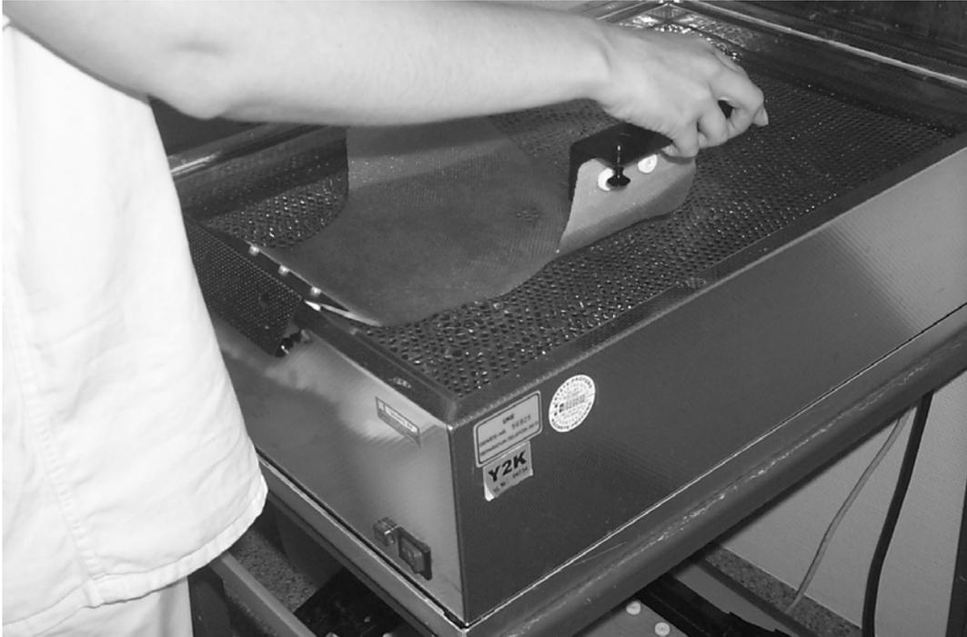
**Abbildung III.4.** Befestigen der Maske an der Tischhalterung.
