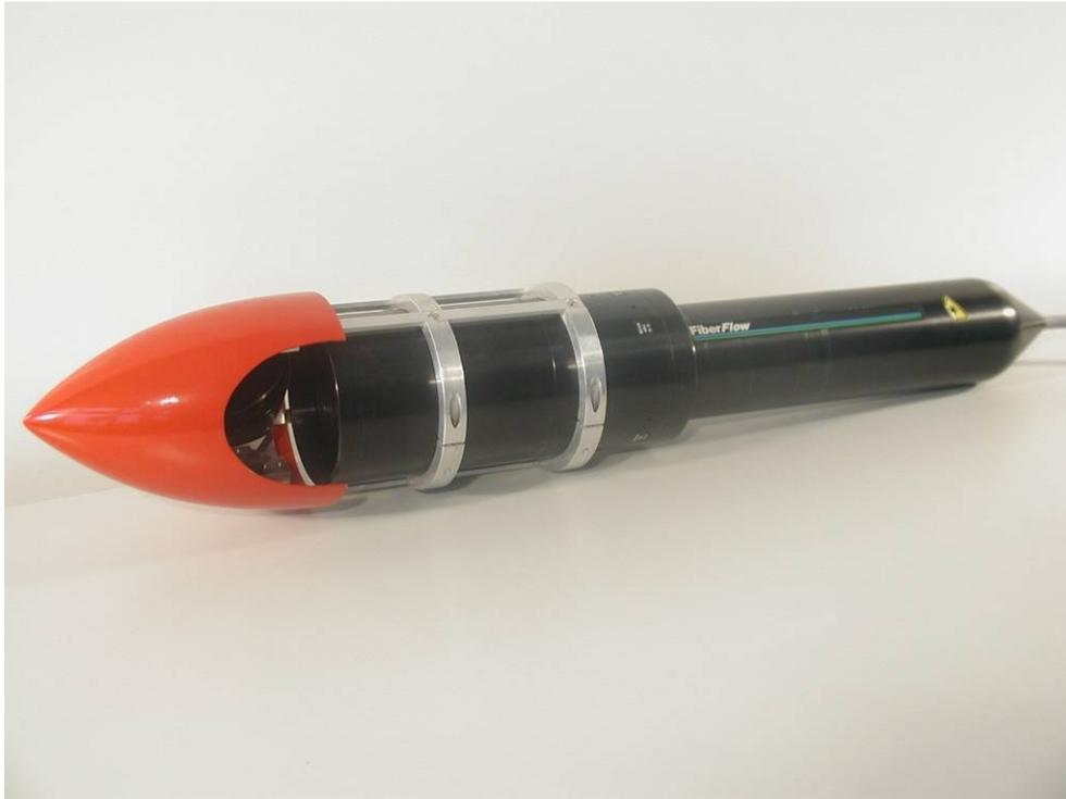
**Abbildung 7:** Große LDA Sonde mit Umlenk-Spiegel und Vorsatz.
