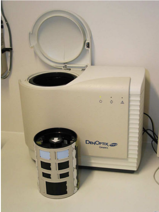
Abb. 15: DenOptix QST System; Trommel mit 2 Speicherfolien (blaue Vorderseite sichtbar)
