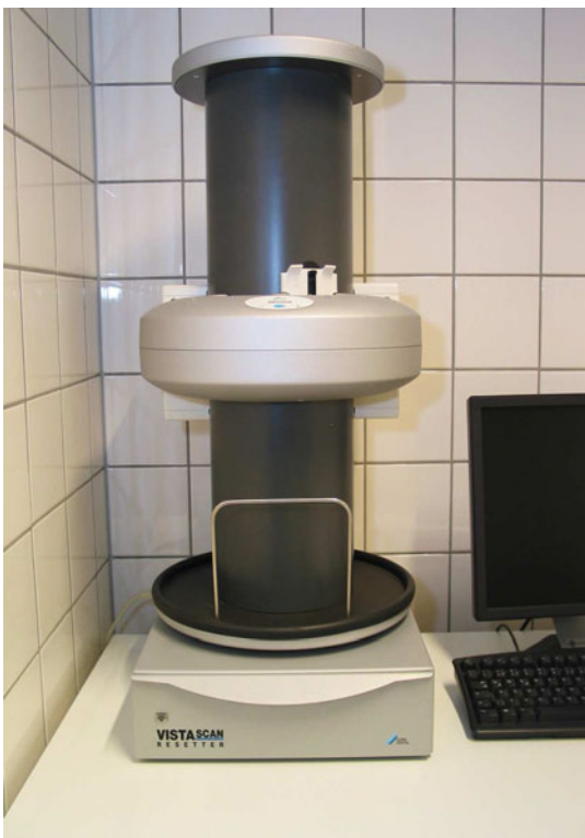
Abb. 17: Dürr VistaScan Ausleseeinheit mit Folienkassette, darunter ist der ReSetter zum Löschen der Speicherfolien
