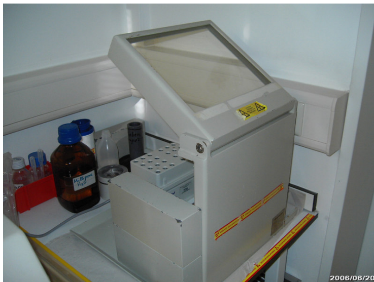
Abbildung 6 Arbeitsplatz für die Synthese von radioaktive Substanzen hinter einer abschirmenden Bleiburg in einem Abzug.
