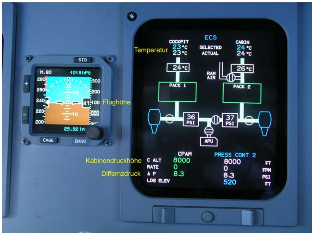
Abb. 3-16: Cockpitinstrumente: Gegenüberstellung Flughöhe, Kabinendruckhöhe und  $\Delta P$
