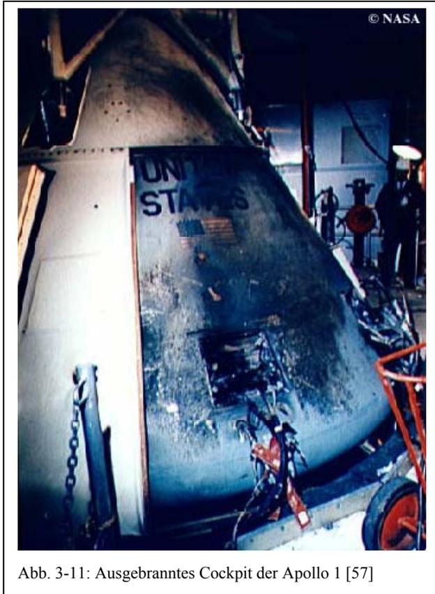
Abb. 3-11: Ausgebranntes Cockpit der Apollo 1 [57]
