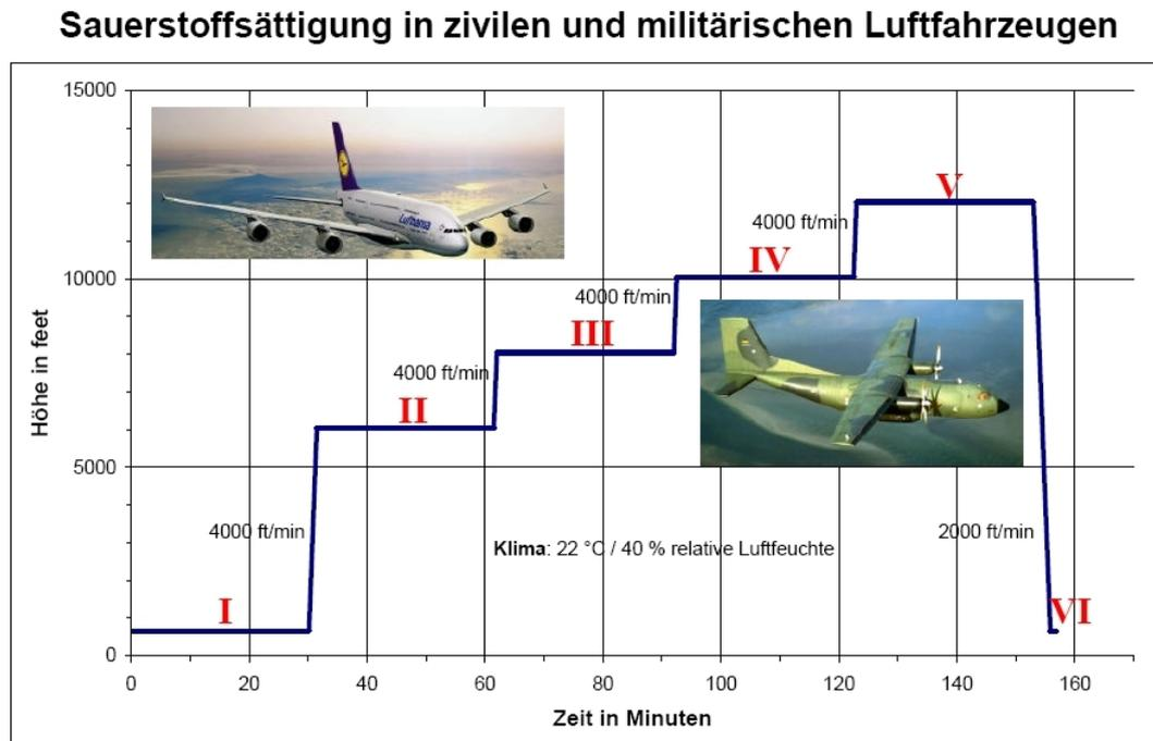
Abb. 4-8: Simuliertes Flugprofil von zivilen und militärischen Luftfahrzeugen
