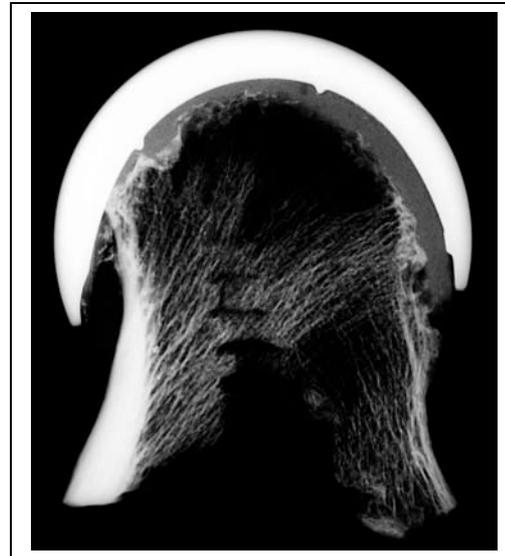
Mit einer Stahlkappe überzogener Hüftkopf. Nach einer Anfertigung von ca. 10 mm dicken Sägeschnittflächen durch diesen Hüftkopf, sieht man unter der Stahlkappe Knochenzement sowie Knochengewebe mit einer unregelmäßigen Struktur.
