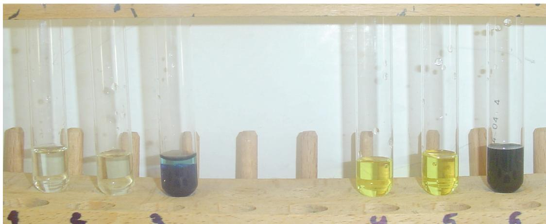
Abbildung 3.4: Nachweisreaktionen zur semiquantitativen Analyse auf Eisen-II-Ionen und Eisen-III-Ionen: (1)Blindprobe, (2)FORT-Puffer, (3)Fe-II-Lösung, (4)Blindprobe, (5)FORT-Puffer, (6)Fe-III-Lösung
