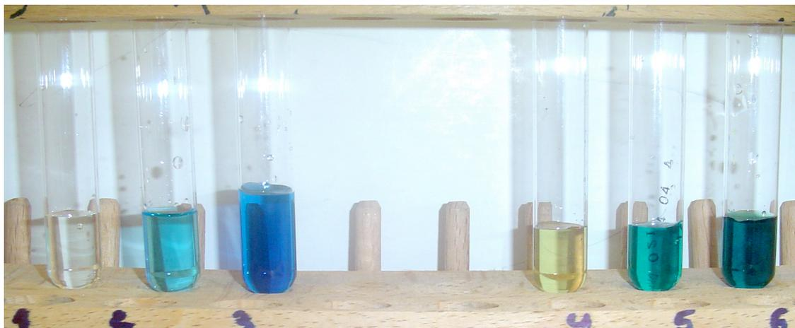
Abbildung 3.7: Nachweisreaktionen zur Analyse auf Eisen-II-Ionen und Eisen III-Ionen in der Chromogenküvette. (1)Blindprobe, (2)FORT-Chromogen in Referenzpuffer, (3)Fe-II-Lösung, (4)Blindprobe, (5)FORT-Chromogen in Referenzpuffer, (6)Fe-III-Lösung
