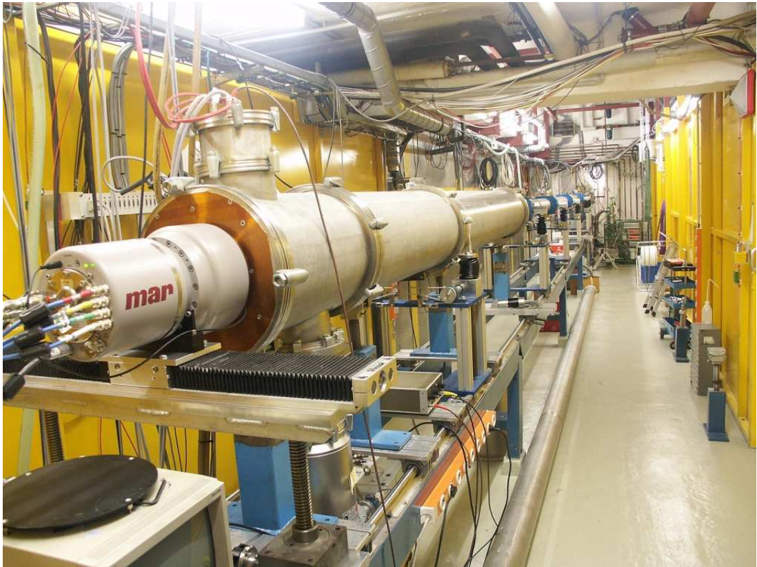
Abbildung 2.7. Beamline BW4 am HASYLAB. Vorne im Bild der MAR-CCD-Detektor. Das lange Vakuumrohr bietet relativ verlustfreie Transmission der Streuung (maximale Länge 15 m). Ganz hinten befindet sich der beamshutter . Die komplette Messstrecke ist gegen austretende Strahlung abgeschirmt
