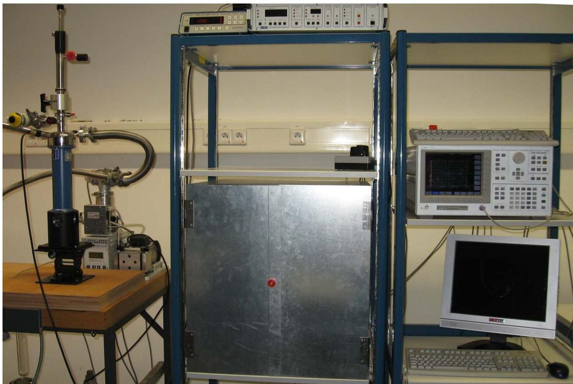
**Abb. 3.16:** OptistatCF-Kryostat von Oxford Instruments (links) und 4156C Precision Semiconductor Parameter Analyzer von Agilent Technologies (rechts). In der Mitte befindet sich die elektrisch abgeschirmte Box mit Mikromanipulatoren und optischer Mikroskopkamera zur Kontaktierung der Elektroden.
