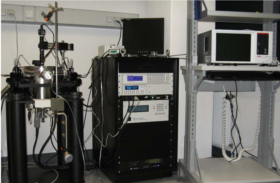
**Abb. 3.14:** Experimenteller Aufbau für die elektrischen Messungen bei tiefen Temperaturen, bestehend aus der VFTTP4 Probestation von Lake Shore Cryotronics (links) und dem 4200-SCS Semiconductor Characterization System von Keithley Instruments (rechts). In der Mitte befindet sich die Steuerungselektronik der Probestation.
