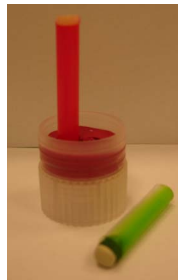
Abb. 3: Probenaufbau für Gruppe B: Schmelzplättchen und GIZ trennbar
