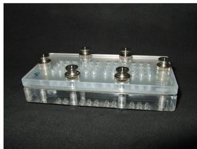
Abb. 15 Zugeschraubte AP48 Mikroammer mit 48 Vertiefungen.
